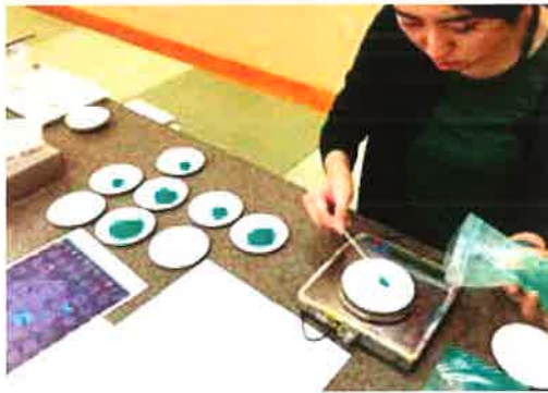
緑青と群青に関しては、顔料の調査で得た質量割合分布表を元に、粒子を配合して使用した。
