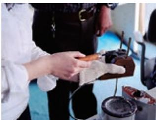
⑩鑄こみ作業 母型(凹)に鉛が主成分の活字合金を流し込み活字(凸)を鑄造
